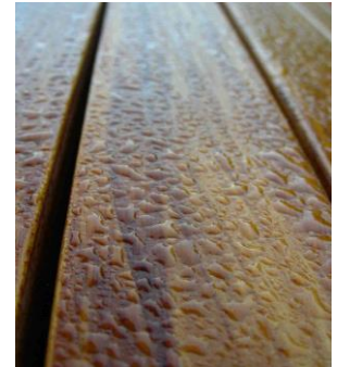
Mit Holzschutzmittel behandeltes Holz.
